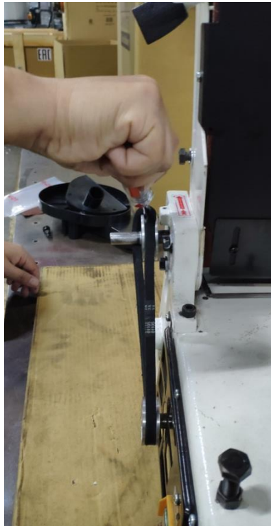
3. Затем натяните ремень на канавку шкива
