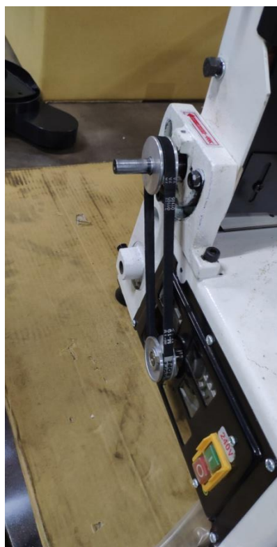
4. Такой способ установки ремня позволяет произвести замену без открепления (регулировки) двигателя, с сохранением хорошего трения между шкивом и ремнем.
