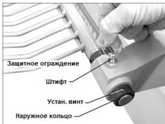
Рис. 6-4: установка защитного ограждения
